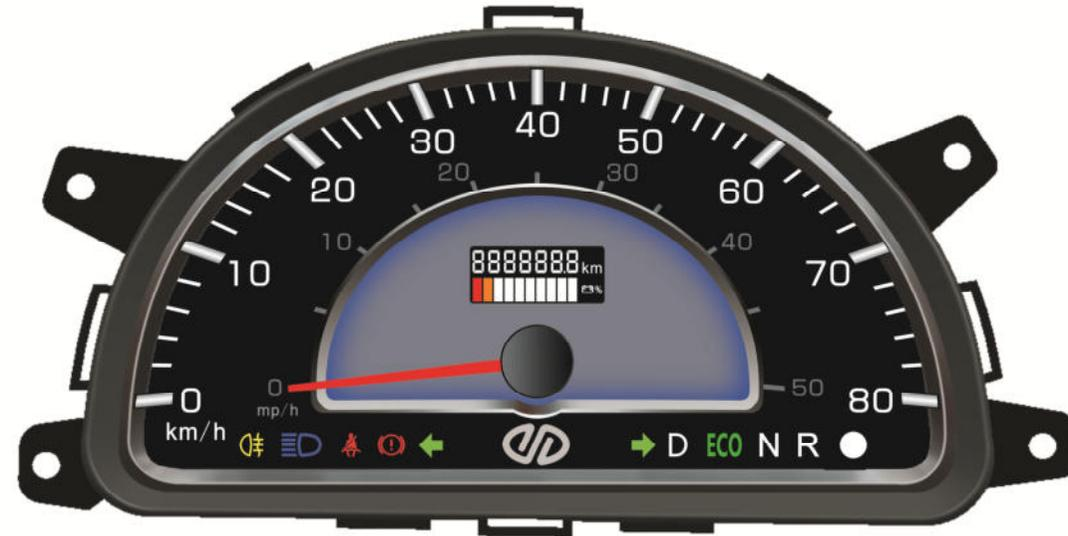
**D** Wenn die Kontrollleuchte "D" leuchtet, die anzeigt, dass sich das Differential in der Fahrgeschwindigkeits-Getriebe-Position befindet.
