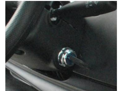
Drehen Sie während der Fahrt den Schlüssel nicht in die Position "LOCK", da sonst das Lenkrad verriegelt und ein Unfall verursacht werden könnte. Lassen Sie den Schlüssel nicht ohne Person oder nur mit einem Kind im Fahrzeug.
